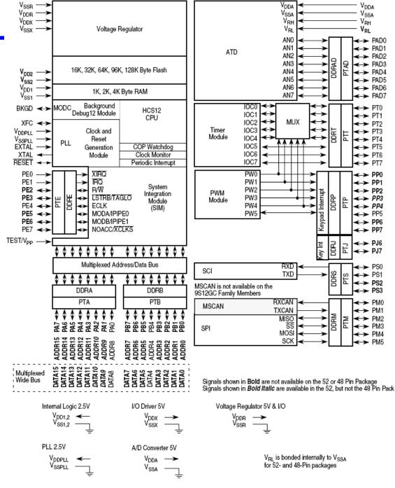
Figure 1-1. MC9S12C-Family / MC9S12GC-Family Block Diagram
