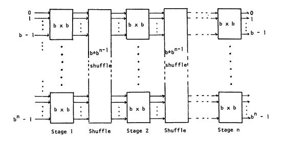
Figure 6. A b<sup>n</sup> x b<sup>n</sup> delta network.
