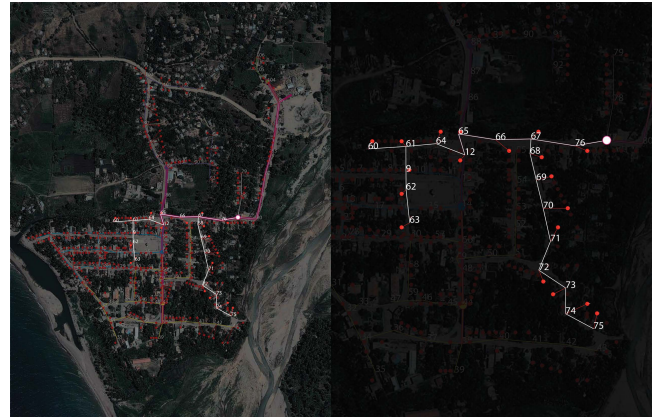
Figure 7: Electrical topology of Les Anglais microgrid subdivision
